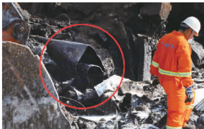
一名消防人员在断裂点附近勘察(红圈处为断裂的输油管道)。新华社发
